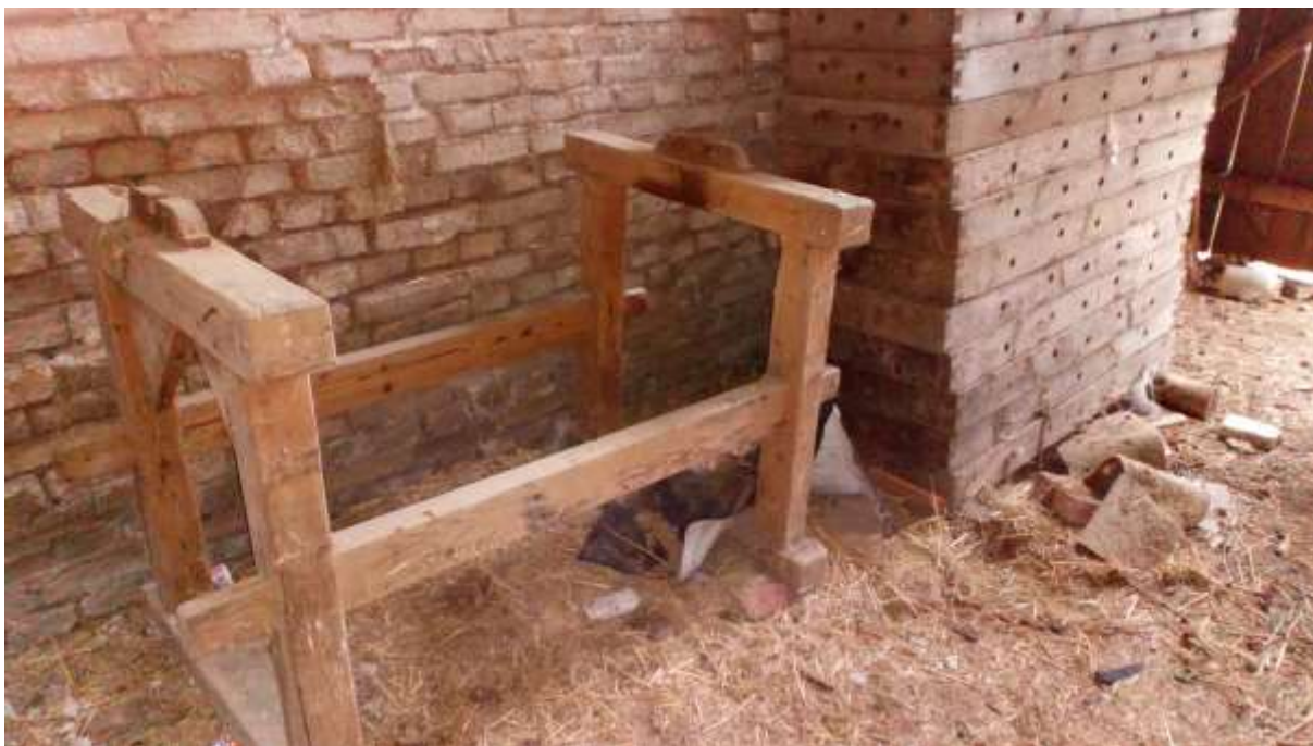
Dřevěná stolice pro umístění rotačního bubnu a vyrovnaná dřevěná sušící síta
